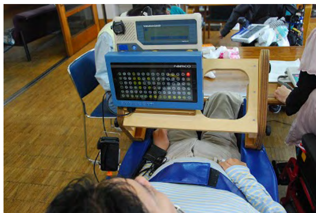
若松泰宏さん = トーキングエイド + オートスキャン + 顎 SW
